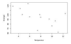
Es ist offensichtlich, dass die Abhängigkeit zwischen der morgendlichen Außentemperatur x und dem Fernwärmeverbrauch y keiner einfachen funktionalen Beziehung folgt, d. h. dass wir keine einfache Funktion angeben können, sodass y=f(x).
